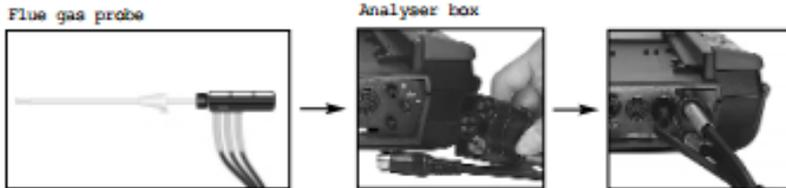
การวัดอุณหภูมิของ flue gas ทำได้โดยใช้เทอร์โมคัปเปิลที่อยู่ตรงปลายของโพรบวัด flue gas ท่อของโพรบจะป้องกันสายเทอร์โมคัปเปิลไว้ แต่ตรงปลายจะเปิด เพื่อให้เทอร์โมคัปเปิลได้สัมผัสกับความร้อน
